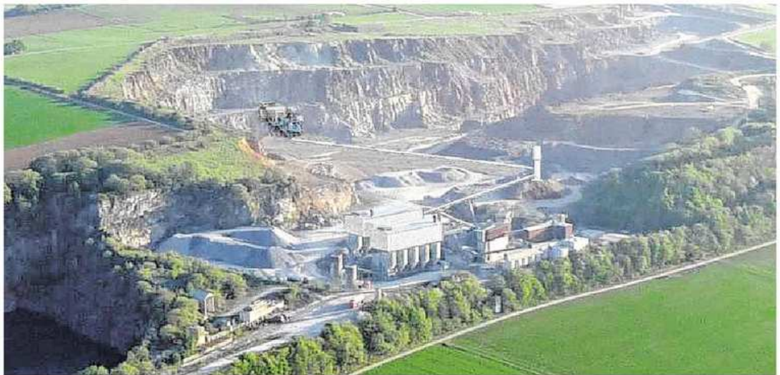
Der Endausbau als Fotomontage: Das helle Gebäude vorne ist die neue Splittanlage, daran schließt sich das Förderband an, das zum neuen Vorbrecher führt. FOTO: WESTKALK
