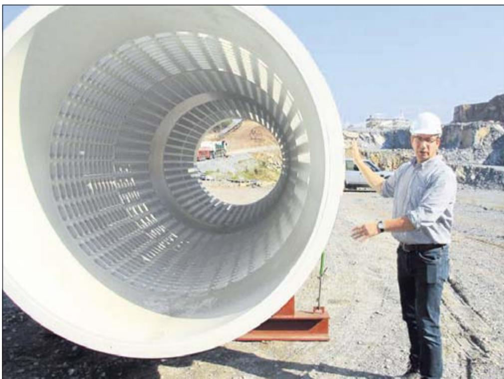
Dr. Guido Mausbach, technischer Leiter bei Westkalk, mit der neuen Siebtrommel, die direkt mit dem abgesprengten Kalk-Lehm-Mix beschickt wird.
