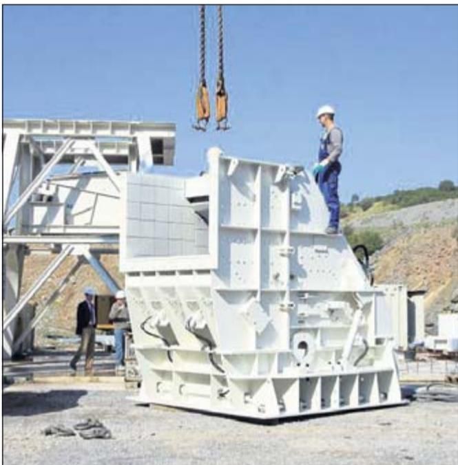
Im Brecher rotiert eine Walze und macht aus bis zu 140 Zentimeter großen Kalkbrocken deutlich kleinere.
