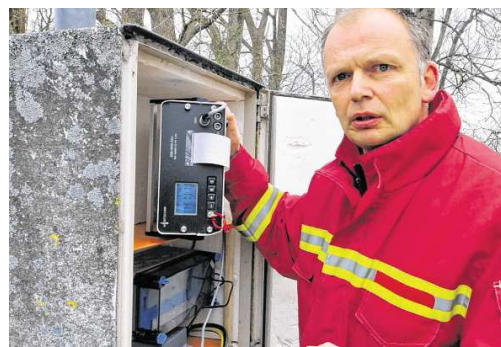
Am sogenannten Referenzpunkt ist ein stationäres Messgerät aufgestellt, das Stefan Teuber nach jeder Sprengung auswertet.
