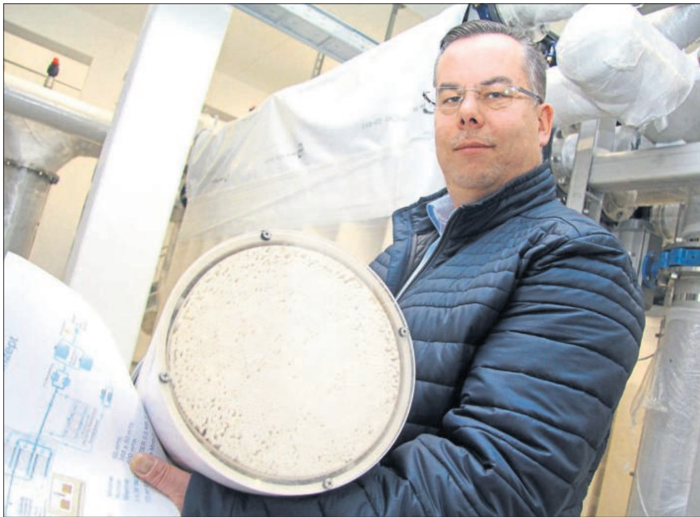
Holger Hellemeier, technischer Leiter und Prokurist bei den Lörmecke-Wasserwerken, hält einen Querschnitt der Membranen der Ultrafiltration in den Händen. Durch die Membranen wird das Wasser gepresst und dadurch entsprechend gereinigt. ■ Fotos: Mund
