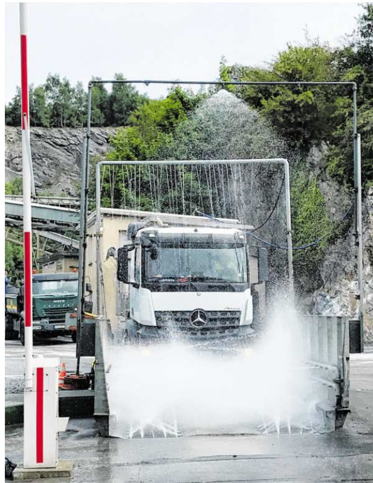
Maßnahmen gegen den Feinstaub: Mit der neuen Reifenwaschanlage schließt Westkalk die Investitionen in den Umweltschutz vorerst ab. FOTO: WESTKALK
